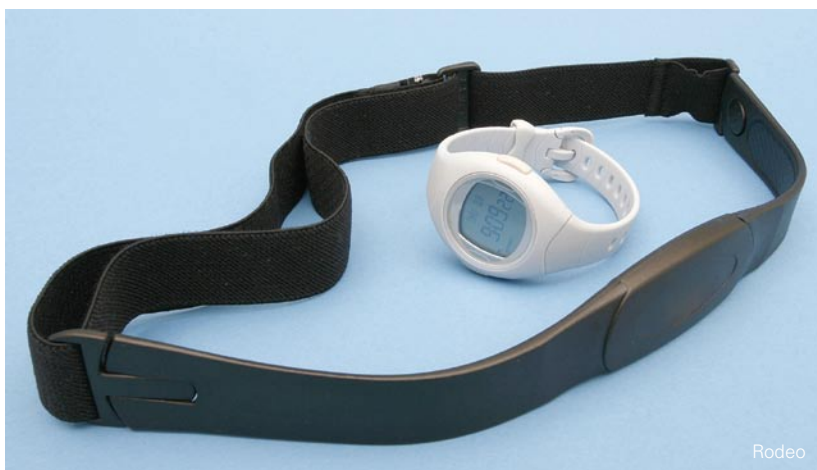
Esimerkiksi sykemittarin vyöosa lähettää tiedon sykkeestä ranteessa pidettävään näyttöön pienitehoisen radiolähtimen avulla.
